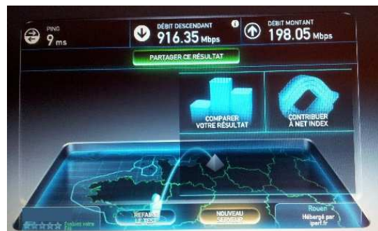
Test de performance d'un accès FttH
